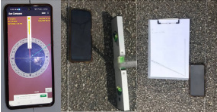
Rajah 6: Proses Cerapan Arah Kiblat Menggunakan Sun Compass
